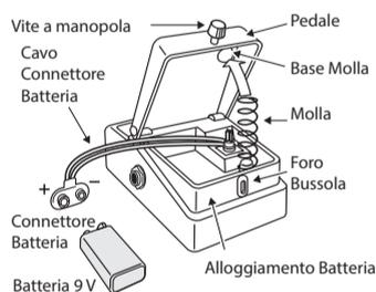
1. Tenete fermo il pedale e allentate la vite per aprire il pedale verso l'alto.
