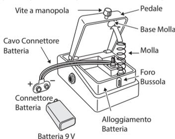
2. Rimuovete la batteria vecchia dal suo alloggiamento e staccate il connettore ad essa collegato.
